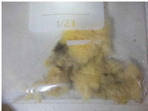
Kuva 30. MAT.05 Mineraalivilla, villassa ulkoilmasta peräisin olevia epäpuhtauksia.
